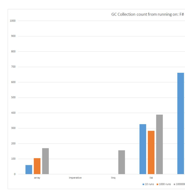
Die Balken zeigen die Gesamtzahl der GC Erfassungszählungen während des Tests an. Weniger ist besser. Dies ist ein Maß dafür, wie viele Objekte von der Datenpipeline erstellt werden.
